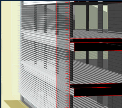
Studio dell'efficacia della schermatura a veneziana per una facciata vetrata a doppia pelle
